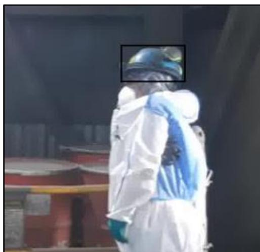
Figura 4.1.2 Detección correcta de casco (true positive) con una puntuación de confianza de 0.976.
